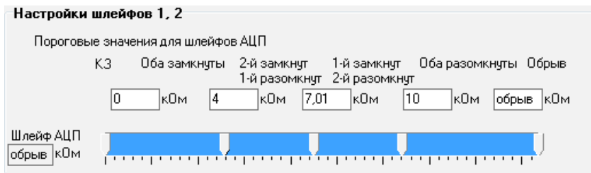
Рисунок 19. Шкала порогов резистивного шлейфа
