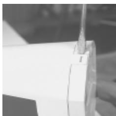
необходимо проверить, чтобы выступ, имеющийся внутри крышки и предназначенный для нажатия на микропереключатель на плате ПРД и ПРМ, находился сверху.
