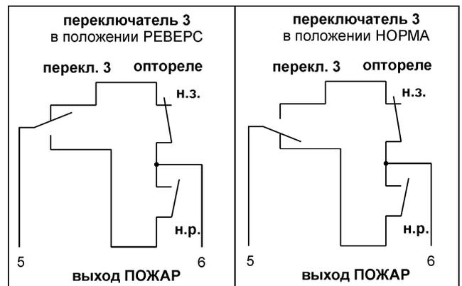
**ПРИМЕЧАНИЕ** - состояние контактов оптореле показано при отсутствии напряжения питания на ПРМ.
