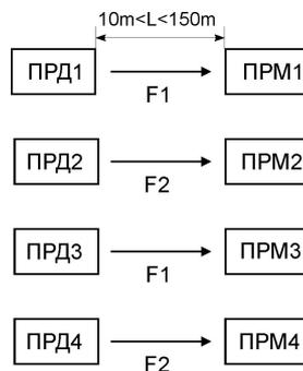
**ПРИМЕЧАНИЕ - не допускается попадание на оптическое окно одного ПРМ двух одинаковых частот излучения от разных ПРД !**
