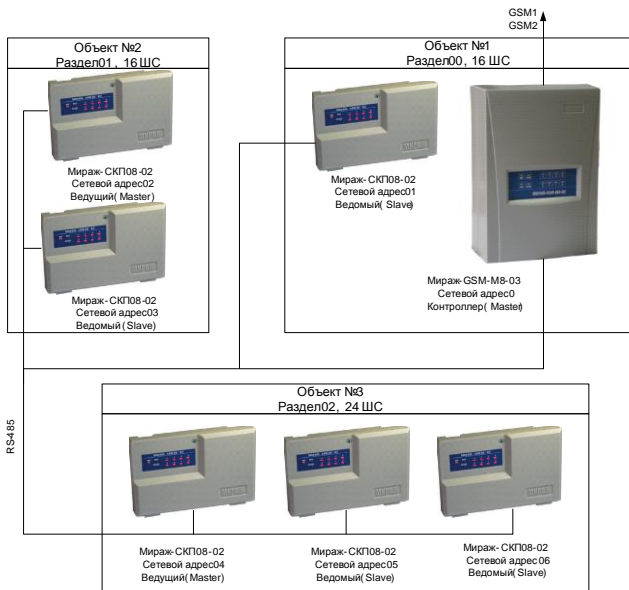
Рис. 4. Вариант построения интегрированной системы для охраны группы объектов
