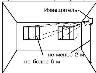
Рис. 3 - Установка извещателя на боковой стене
