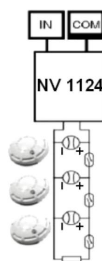
шлейф пожарных двухпроводных извещателей
