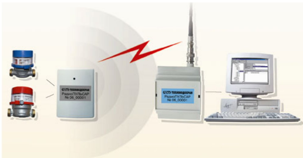
Рисунок 1 - Принцип работы Пульсар 16PM
